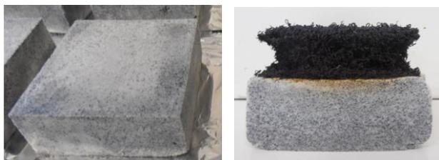
L'enjeu de cette étude de développement réside à la fois dans le choix du « bon » ignifugeant permettant de respecter les critères de réaction au feu de la norme mais également dans le respect du cahier des charges du fabricant (viscosité, aucune perturbation lors de la polymérisation de la mousse, ...).
